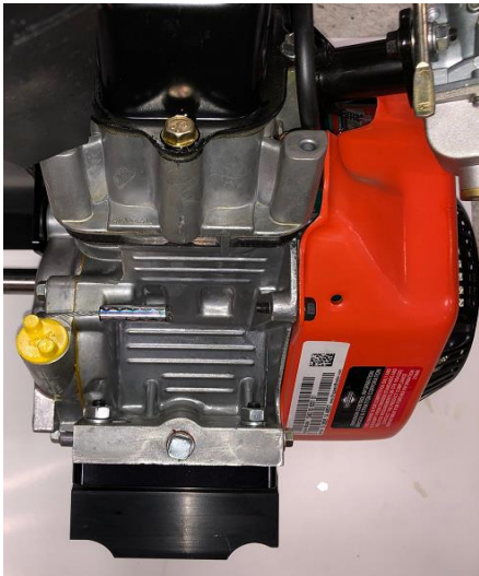
正确 (发动机底板和副板对齐)
