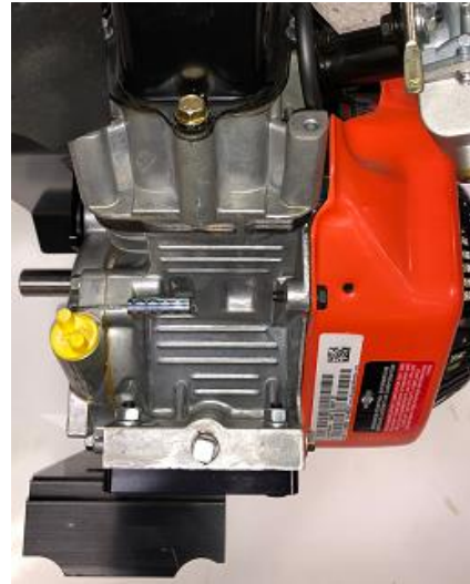
错误 (底板和副板偏移过大)
